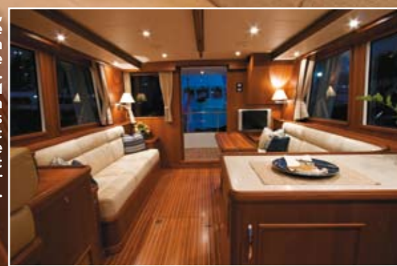
Au premier plan, on distingue le retour du plan de travail, qui sépare la cuisine du salon. Notez au plafond la main courante en teck et les coffrages discrets, dissimulant la membrane invisible qui fait office de sortie d'air conditionné.
