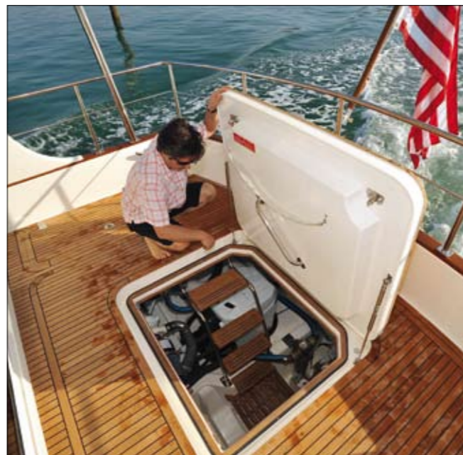
La soute moteur est sous le cockpit et non plus sous la timonerie. Le niveau sonore dans l'habitacle a considérablement diminué.
